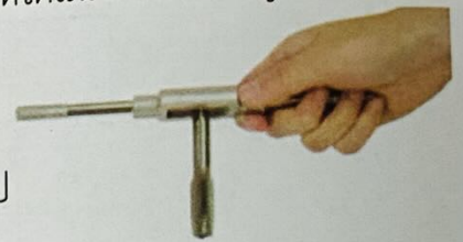
รูปที่ 5.44 นำดอกตាប់จับยึดด้วยด้ามต่าย
