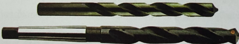
รูปที่ 5.5 ดอกสว่านก้านตรงและสว่านก้านเรียว
